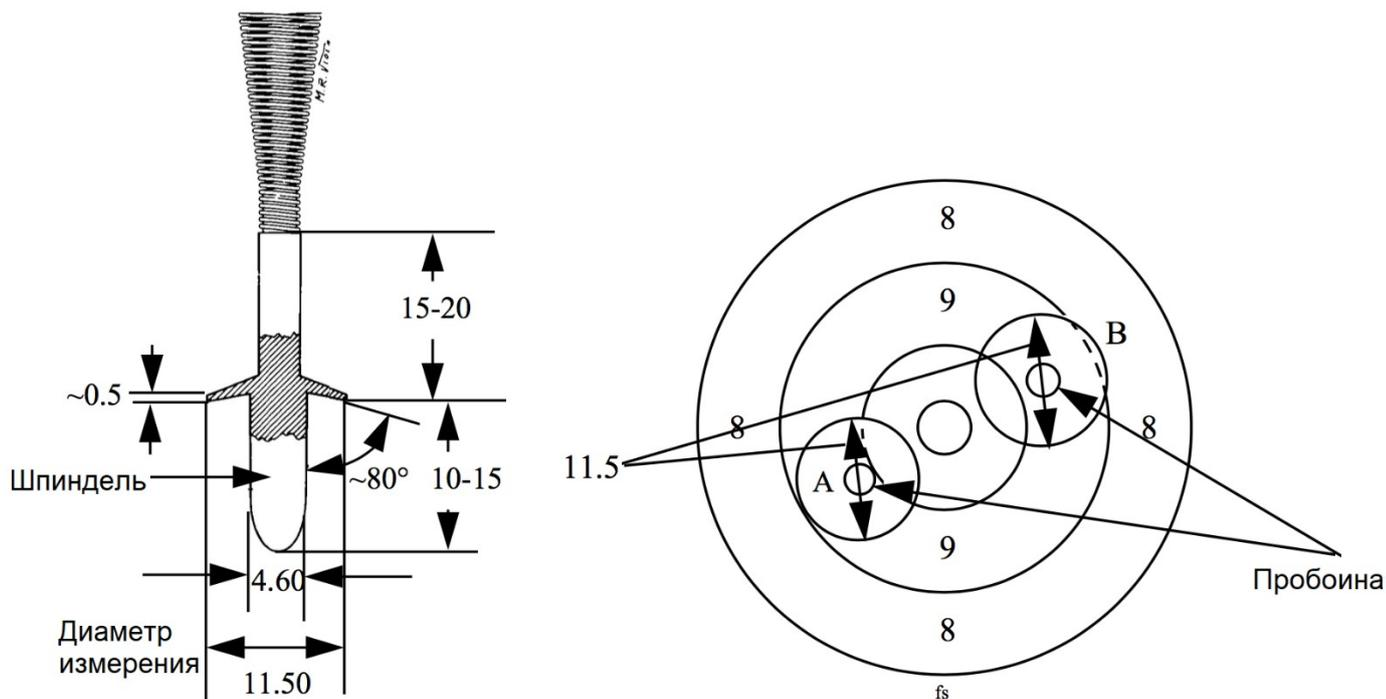
Рисунок “А” показывает сомнительную пробоину с установленным внешним счётным средством измерения. Внешний борт фланца наружного калибра находится внутри габарита 9; поэтому значение выстрела – 10.
