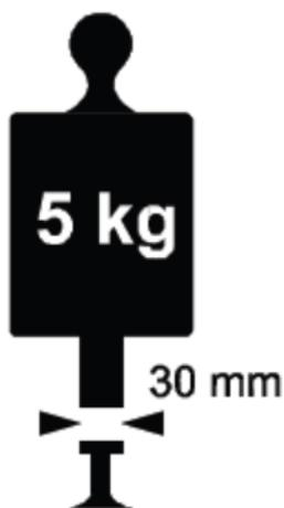
Устройство для измерения толщины одежды и обуви должно иметь цену деления в одну десятую миллиметра (0.1 мм). Измерения должны проводиться с использованием веса в 5.0 кг. Устройство должно иметь два (2) круглых плоских диска, с поверхностью, обращенной друг к другу, каждый диаметром 30 мм.
