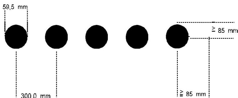
Диаметр чёрной зоны – 59.5 мм с погрешностью +0.2 мм / - 0.0 мм
