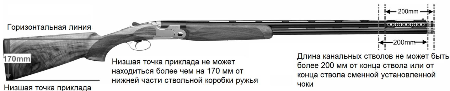
Низшая точка приклада или пяты затыльника приклада не может быть расположена ниже, чем на 170 мм, если мерить от горизонтальной линии, проходящей от нижней части ствольной коробки (см. иллюстрацию).
