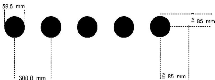
Диаметр чёрной зоны – 59.5 мм с погрешностью +0.2 мм / - 0.0 мм
