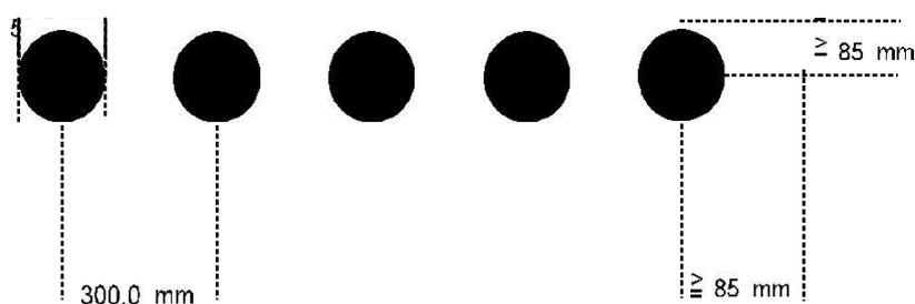
Диаметр чёрной зоны – 59.5 мм с погрешностью +0.2 мм / - 0.0 мм
